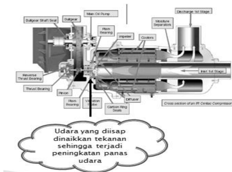
Gambar 2. 2 Bagian-bagian kompresor sentrifugal ( Ingersol, 2000 )
