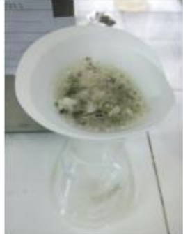
Penyaringan dengan kertas saring wathman no.1
