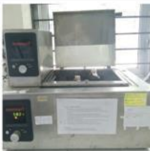
Ekstraksi dengan menggunakan shaker water bath selama 6 jam
