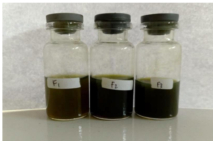
Figure 2. Nanoparticles Suspension: F1 (50 mg PLGA), F2 (75 mg PLGA), dan F3 (100 mg PLGA)
