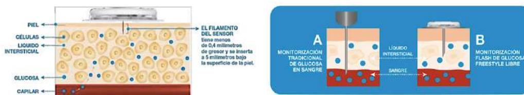
**Figura 29:** Esquema de funcionamiento del sensor de medición de glucosa intersticial. Diferencias entre el sistema tradicional de detección de glucemia capilar y la monitorización continua de glucemia (159).
