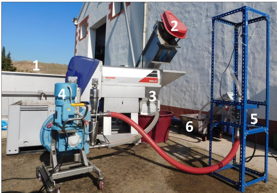
Figura 37: Equipos instalados y utilizados en “Bodegas Aragonesas” para realizar la implementación de los PEAV a escala de bodega (foto Marcos Maza). (1) Tolva de recepción. (2) Tornillo sin-fin. (3) Despalilladora. (4) Bomba peristáltica. (5) Cámara de PEAV. (6) Bomba de tornillo helicoidal.
