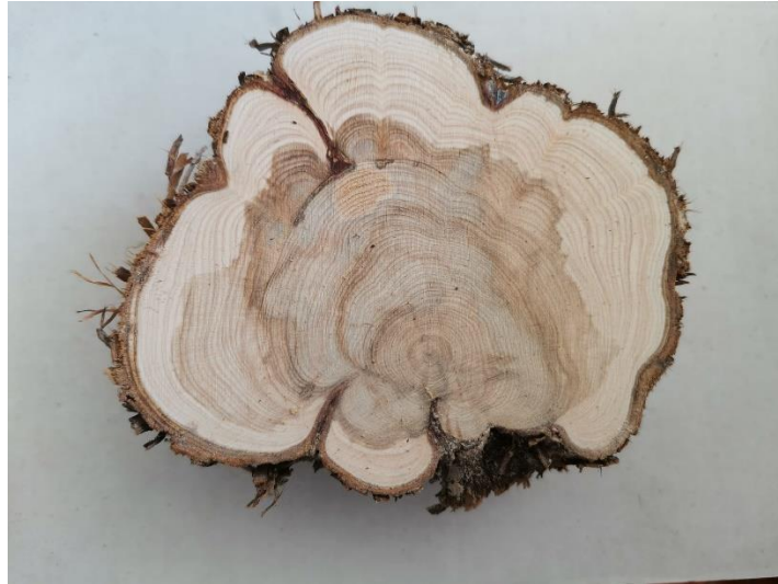
Figura 18: Fotografía de una rodaja de J. communis tras pasar la lija de 60pp.
