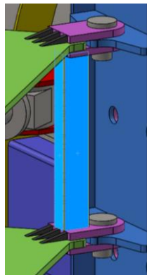
Imagen 4.22 Imágenes del perfil rigidizador de conexión (izquierda) y los rigidizadores verticales (derecha).
