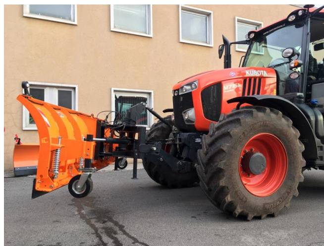
Imagen 1.5 Apero quitanieves con hoja de empuje plana-curvada con ángulo variable.
