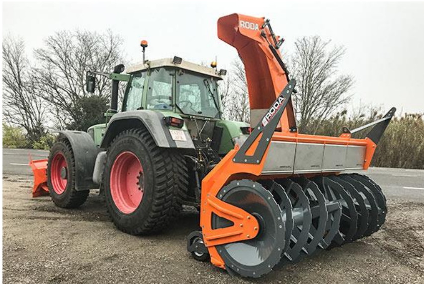
Imagen 1.1 Apero quitanieves dinámico con turbina.
