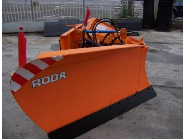
Imagen 1.4 Apero quitanieves con hoja de empuje en cuña y ángulo variable.
