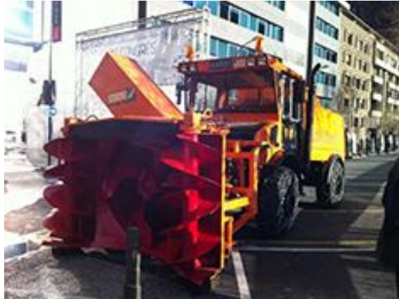
Imagen 1.2 Apero quitanieves dinámico con turbofresa.
