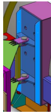
Imagen 4.22 Imágenes del perfil rigidizador de conexión (izquierda) y los rigidizadores verticales (derecha).
