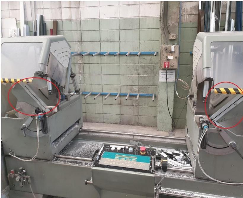
*Figura 40. Cabezales de corte de la mesa de corte.*
