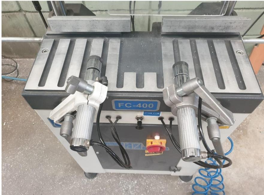
*Figura 47. Utillajes de la fresa-copiadora.*
