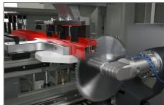
Figura 57. Cuchilla de corte horizontal.
