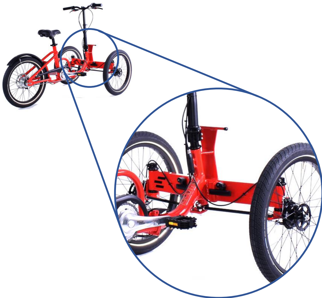
Figura 36. Sistema de dirección y estructura del triciclo de "etnnic" [17].
