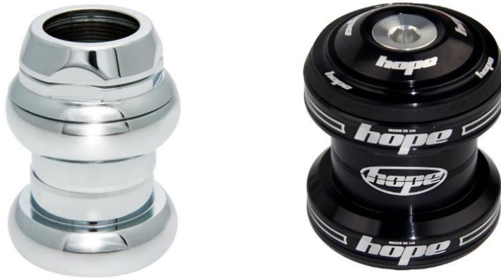
Figura 7. Dirección roscada (izquierda) y dirección "Threadless" (derecha).
