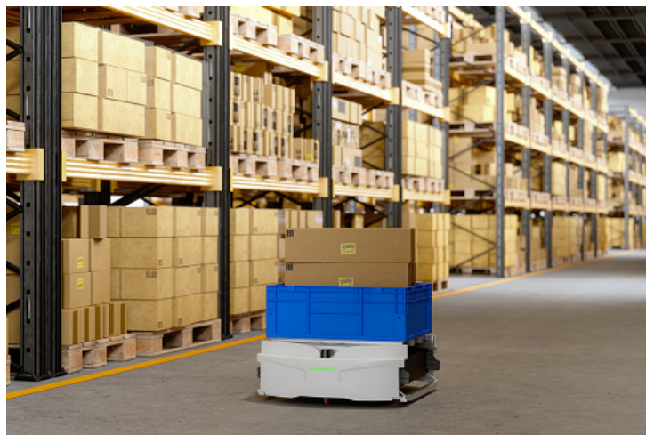
Figura A.2: Robot móvil autónomo de tipo AGV empleado en plantas industriales.
