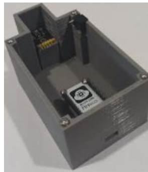
Imagen 37. Carcasa del producto con los componentes internos fijados.
