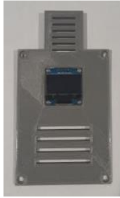
Imagen 36. Tapa del producto con la pantalla OLED fijada.
