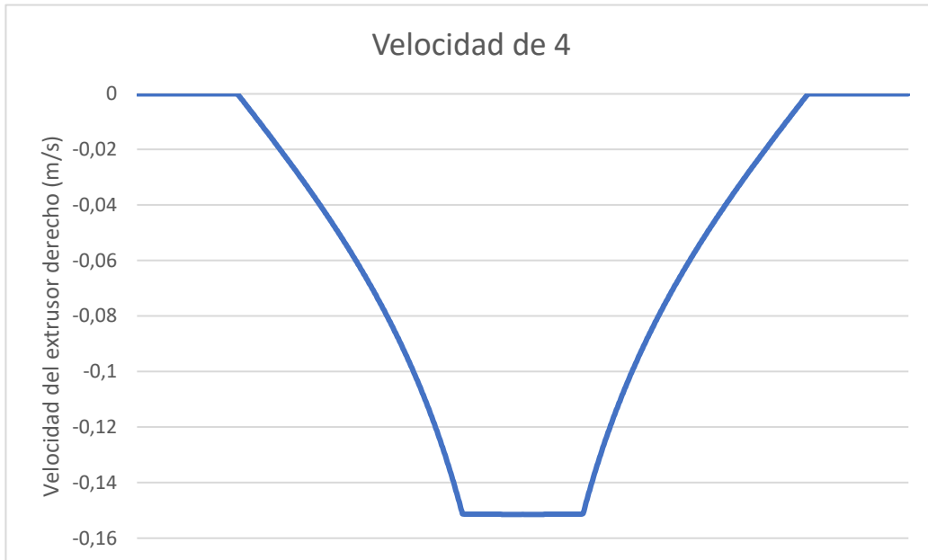
Figura 77. Resultado de la velocidad del extrusor derecho con el programa desarrollado
