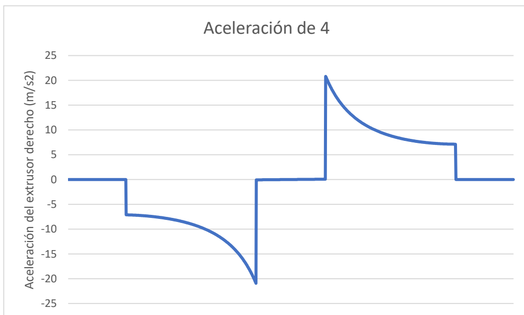
Figura 78. Resultado de la aceleración del extrusor derecho con el programa desarrollado
