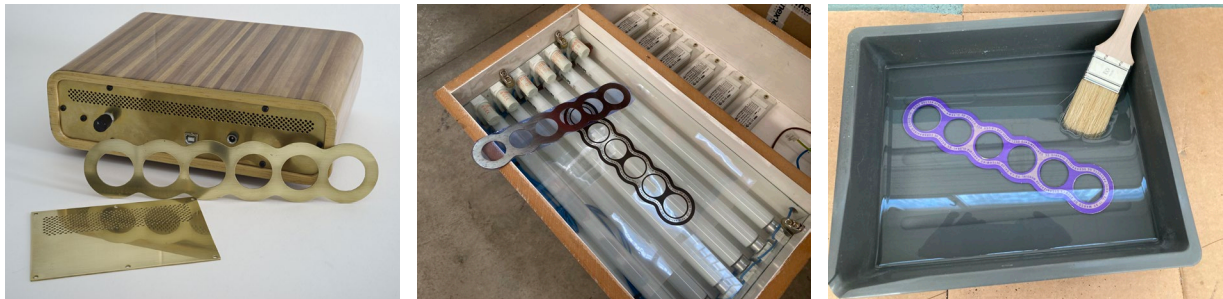
Figura 1.4.4. Detalles latón y pruebas del grabado al ácido de la placa frontal
