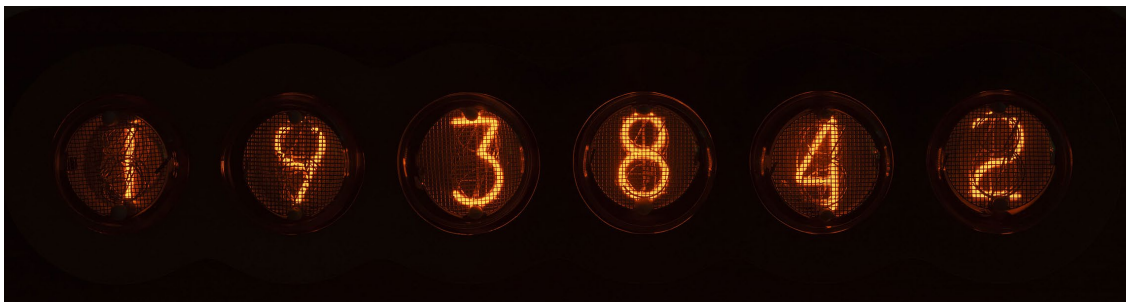
Figura 1.4.7. Colocación tubos Nixie
