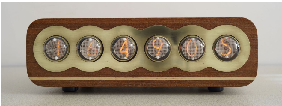
Figura 1.5.23. Colocación de la pieza de latón sin grabar en la parte delantera
