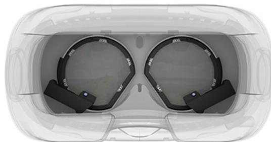
Figura 1.4: Imagen del dispositivo de *eye tracking*, integrado en las gafas de realidad virtual
