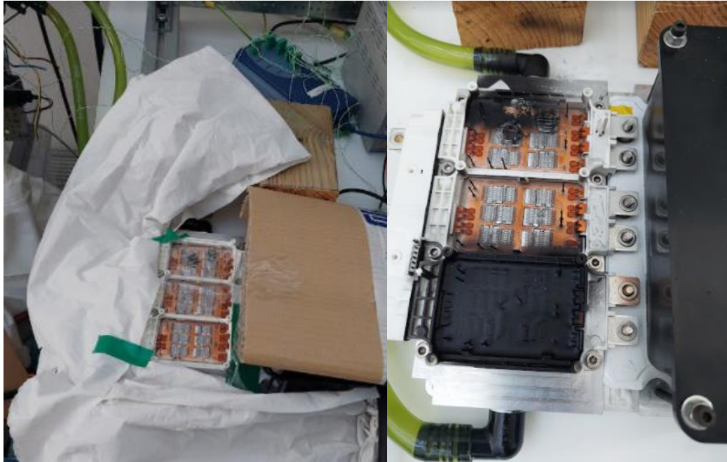
Figura 21- Preparación de la pintura térmica sobre la rama del módulo.
