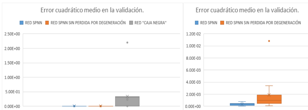
Figura 5.4: Diagramas de caja para del error cuadrático medio en la prueba de validación en los tres tipos de redes.
