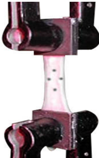
Figura 4.1: Ejemplo de un ensayo de tracción en un tejido vivo (Fuente: Internet).
