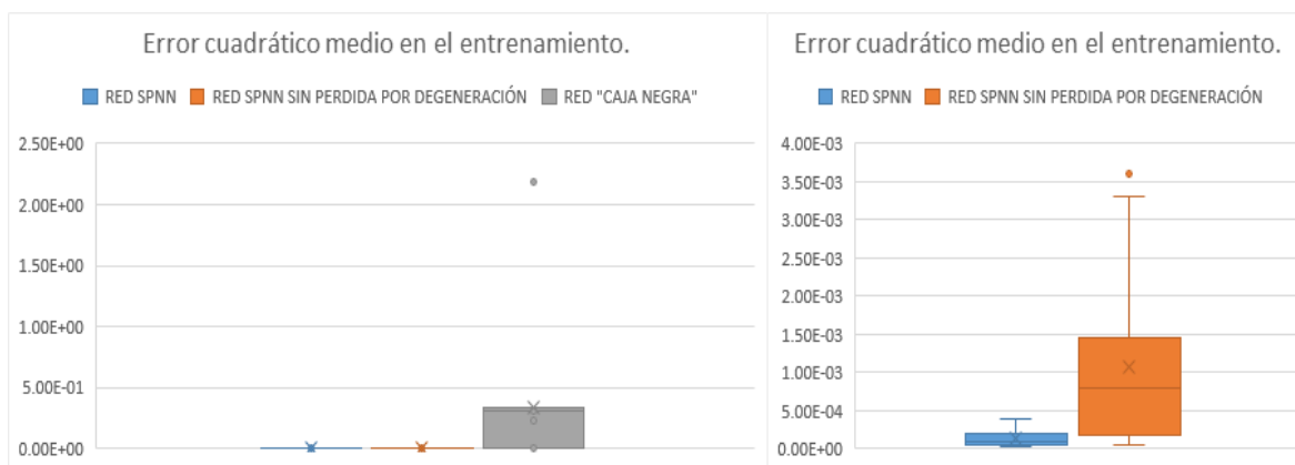
Figura 5.3: Diagramas de caja para del error cuadrático medio en el entrenamiento en los tres tipos de redes.
