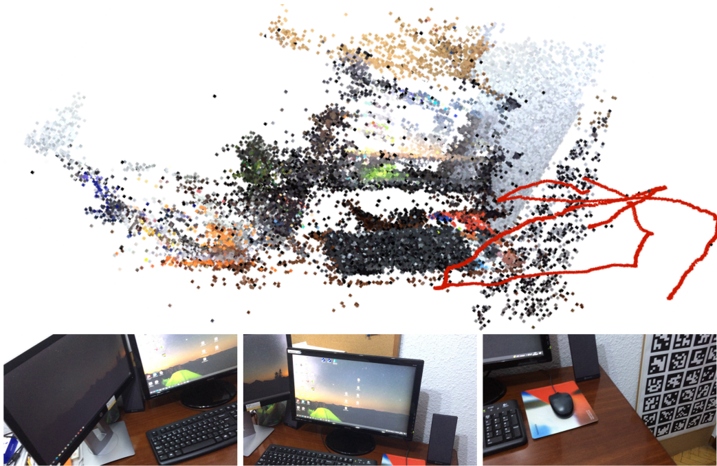
Figura 2.9: Ejemplo de reconstrucción mediante COLMAP. La línea roja representa la trayectoria estimada que siguió la cámara que capturó las fotos usadas en la reconstrucción 3D de la escena (3 de ellas se muestran en la parte inferior). Destacar como el software es capaz de reconstruir tanto la estructura global de la escena como pequeños detalles (p.ej. teclas).
