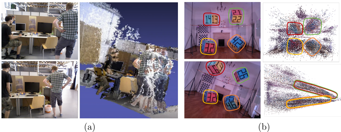
Figura 1.4: (a, izda) Par de instantes del dataset [Sturm et al., 2012a], en el que dos personas se mueven por el lugar en el que los sensores están captando información. (a, dcha) Mapa estimado mediante SLAM [Bescos et al., 2018]. Debido a la asunción de estaticidad, las personas aparecen repetidas veces en él. (b, izda) Par de instantes del dataset [Judd and Gammell, 2019] en el que aparecen cajas moviéndose mediante un mecanismo de poleas. (b, dcha) Mapa estimado (visto de frente y de perfil) mediante SfM . En este caso, el movimiento de los objetos provoca la aparición de una estela de puntos que erróneamente se atribuye a entidades estáticas.
