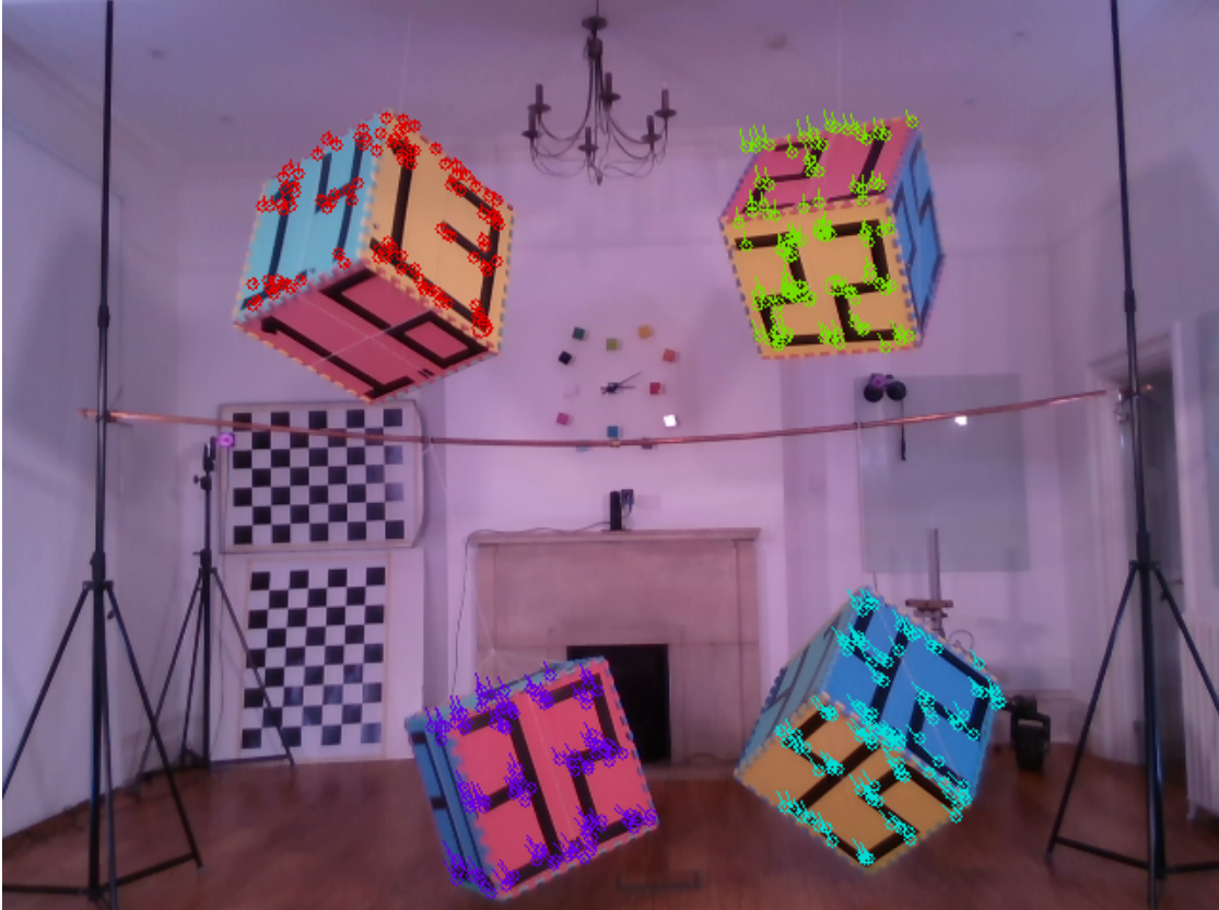
Figura 5.2: Detección y seguimiento mediante flujo óptico de características Shi-Tomasi mediante KLT. Los círculos representan la posición actual de las características detectadas. Las líneas representan la trayectoria que han seguido en la imagen.
