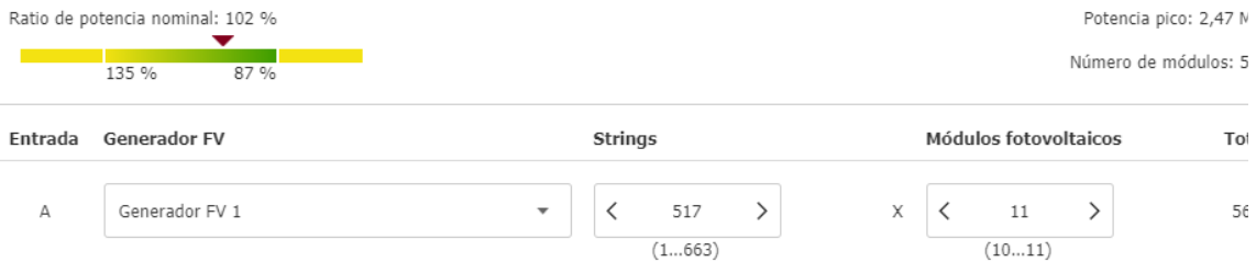
Figura 11. Simulación en Sunny Design, configuración 517x11
