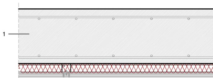
1. Muro de hormigón armado con armadura B-500S,  $\varnothing 12c/20$  cm
