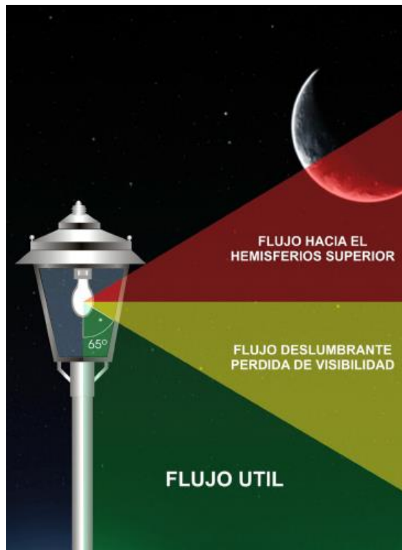
Figura 75: Ilustración para comprender en que consiste el flujo hemisférico superior (FHSi). Fuente: Fundación Starlight.
