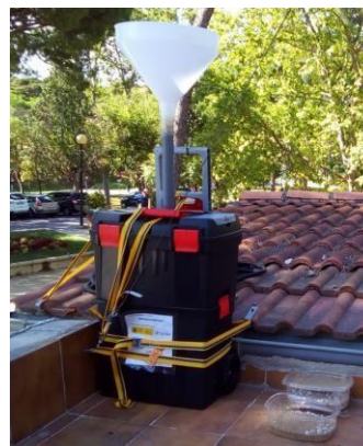
Figura 6. Esquema de un colector deposición atmosférica (izquierda) y colector real usado en la red DONAIRE (derecha). Fuente: Jorge Pey Betrán e Inés de la Parra
