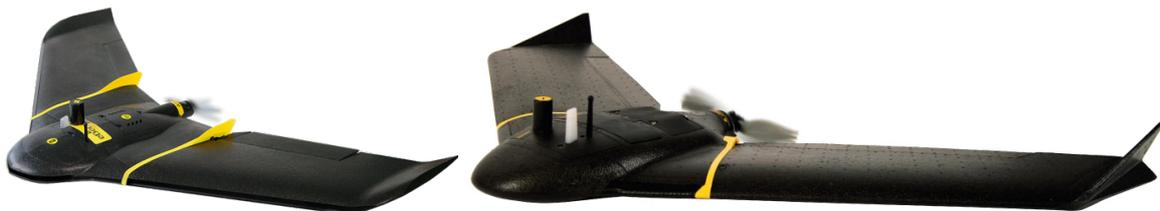
Imagen 3: Modelos *senseFly eBee Plus* y *senseFly eBee X*, respectivamente. Fuente: Catálogos *senseFly eBee Plus* y *senseFly eBee X*.
