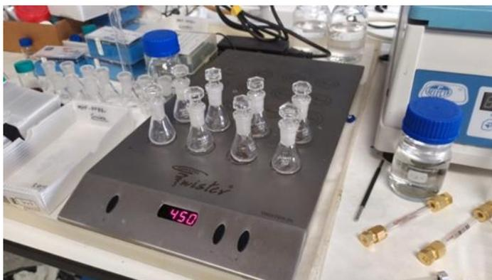
*Figura 4: Barras "Twister" agitándose a 450 rpm durante el experimento de optimización*
