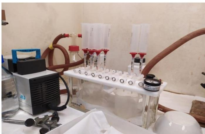
*Figura 5: Sistema de vacío semiautomático para SPE.*
