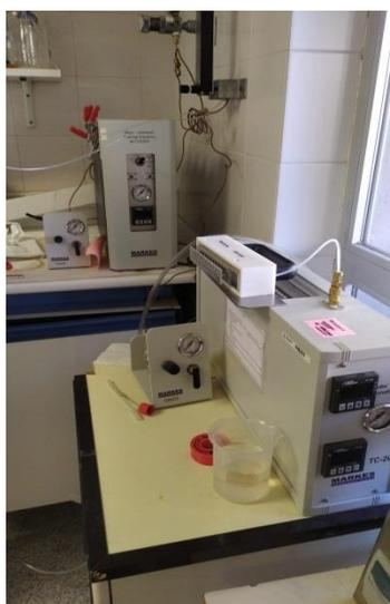
*Figura 3: Acondicionador de tubos de sorción y flujo de Nitrógeno usados en el estudio*
