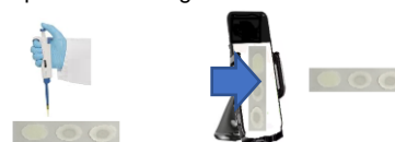
Figura 18: Inyección/es sobre el disco de papel y captura de la imagen
