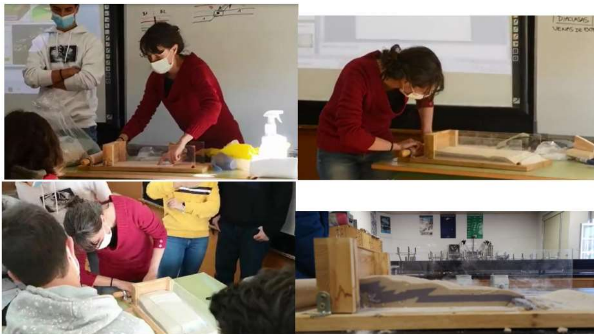
Fig. 10. Imágenes del mini-laboratorio empleado para hacer el modelo analógico, del proceso de deformación de las capas de arena y del resultado final.
