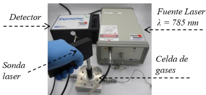
Figura 2.2 Equipo Raman portable BWTEK utilizado durante la caracterización de los sustratos SERS.
