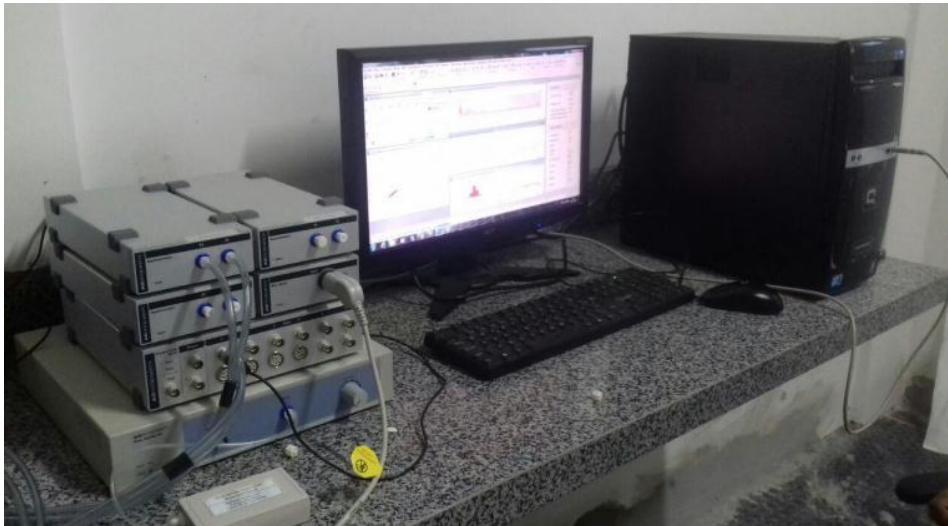
Figura 4 - Sistema de aquisição de dados monitoração multimodal de biosinais Powerlab PL3508 (AD Instrument – Austrália) utilizado para realização do experimento
