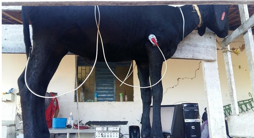
Figura 5 – Posicionamento dos eletrodos sob a pele do ovino para obtenção dos valores eletrocardiográficos
