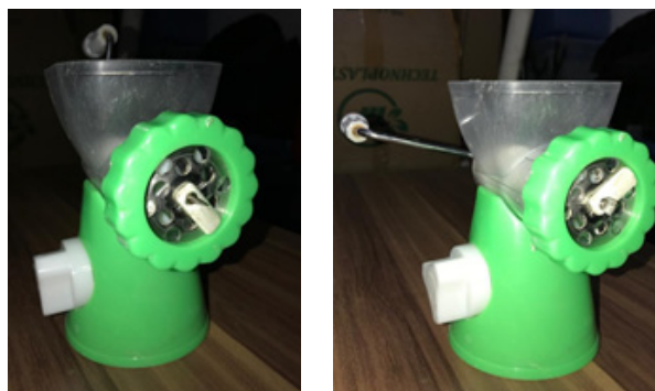
Gambar 1. Mesin penggiling daging yang dimodifikasi dengan penambahan baling
