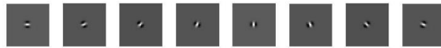
Gambar 3.6. Gabor filter bank dengan delapan orientasi untuk mendeteksi tepi pada daerah mata.
