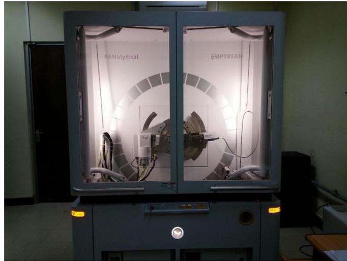
**Gambar 2. 6** Alat Pengujian XRD PANalytical
