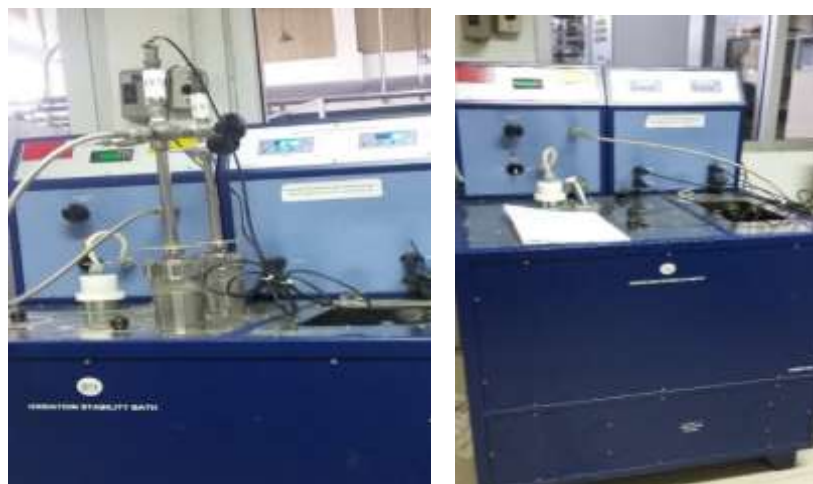
Gambar 31. Rangkaian Alat Uji Periode Induksi
