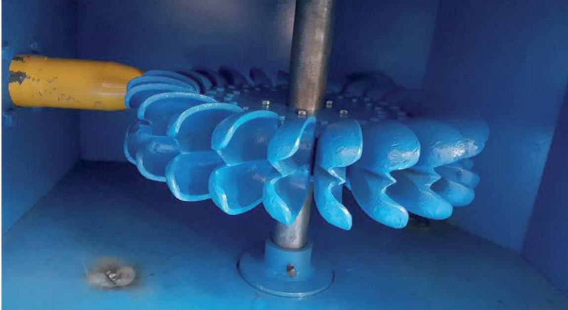
FIGURA 27. Rodete de una turbina Pelton fabricada por FHIA
