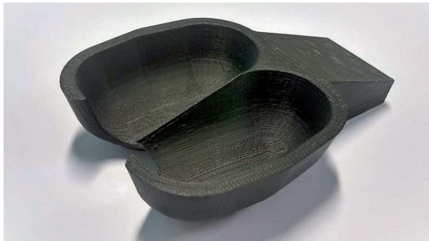
FIGURA 34. Modelo de una cuchara Pelton fabricado mediante fabricación aditiva para su posterior réplica en acero mediante fundición en arena
