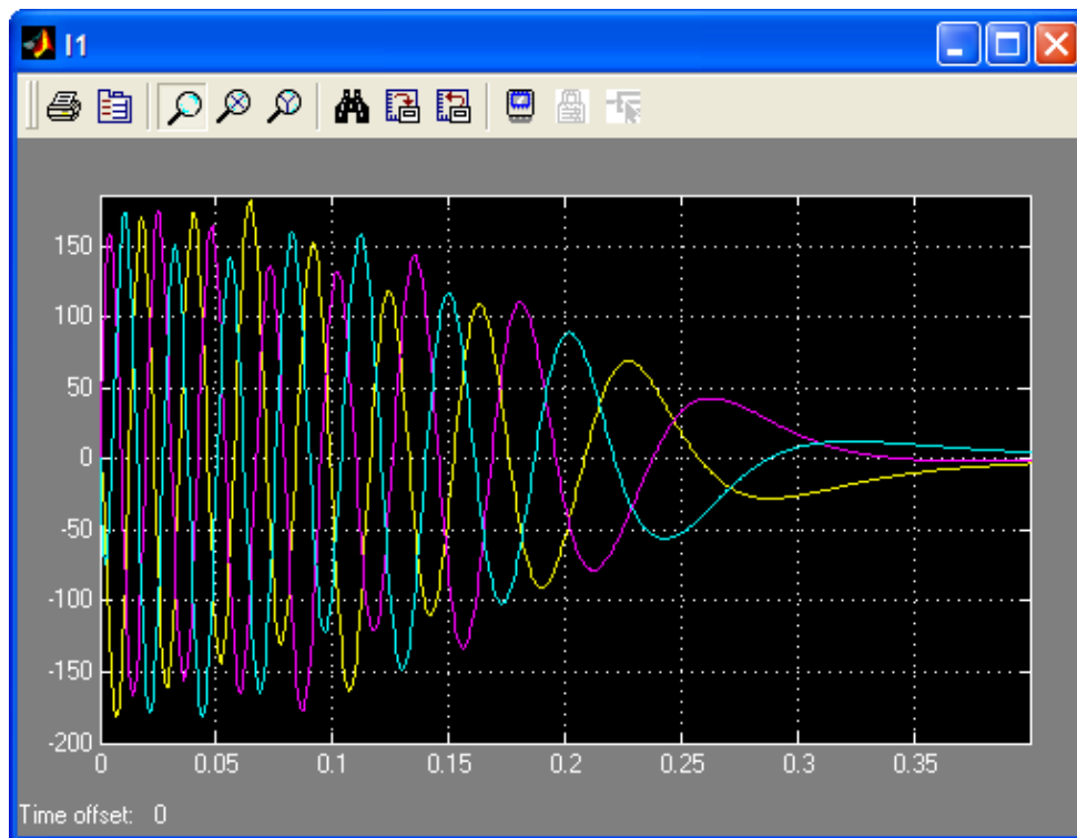
Рисунок 2.19 – Графіки змінення струмів, що протікають по фазних обмотках статора з M_c = 0
