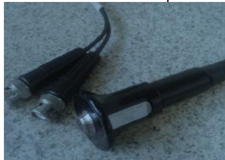
Figura 19. Palpador de frecuencia de 5 MHz – Tipo dual.
