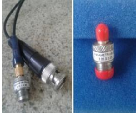
Figura 20. Palpador de frecuencia de 2.25 MHz – Tipo pulso-Eco.
