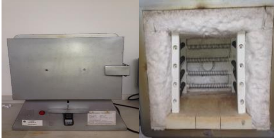
Figura 13. Horno tipo mufla M10.
