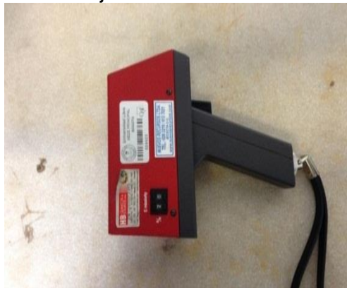
Figura 14. Termómetro infrarrojo OMEGA.
