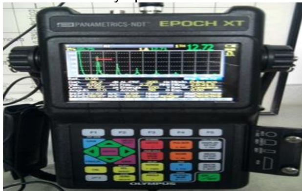
Figura 18. Equipo de ultrasonido Olympus - EPOCH XT.
