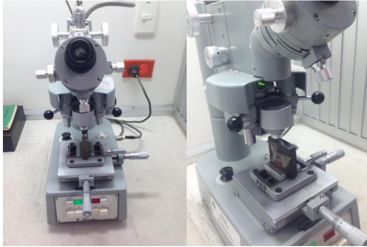
Figura 22. Microdurómetro – EQ - M. AM, 03.
