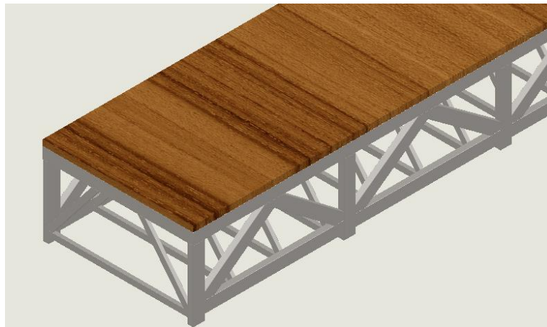
Figura 4. Base del molde de inyección
