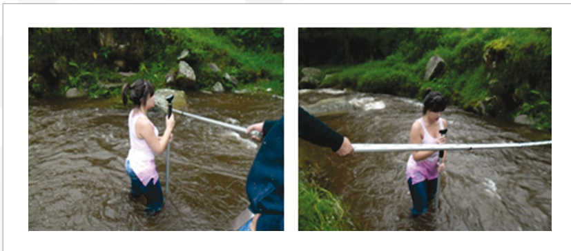
Figura 33 Aforo en la quebrada Potrero Grande.
