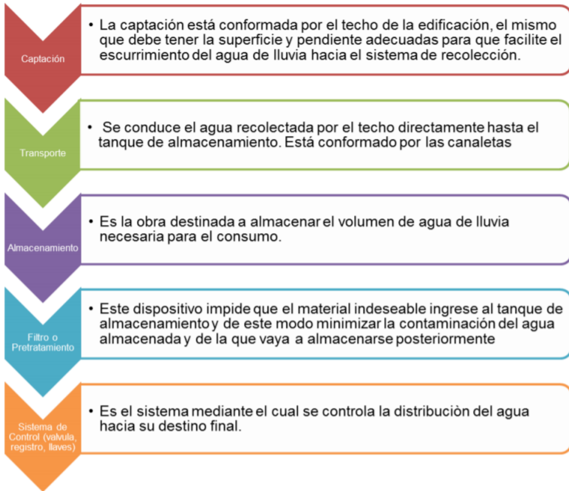
Figura 3. Proceso de Sistema de Recolección de Aguas Lluvias por Métodos de Canales de Cubiertas
