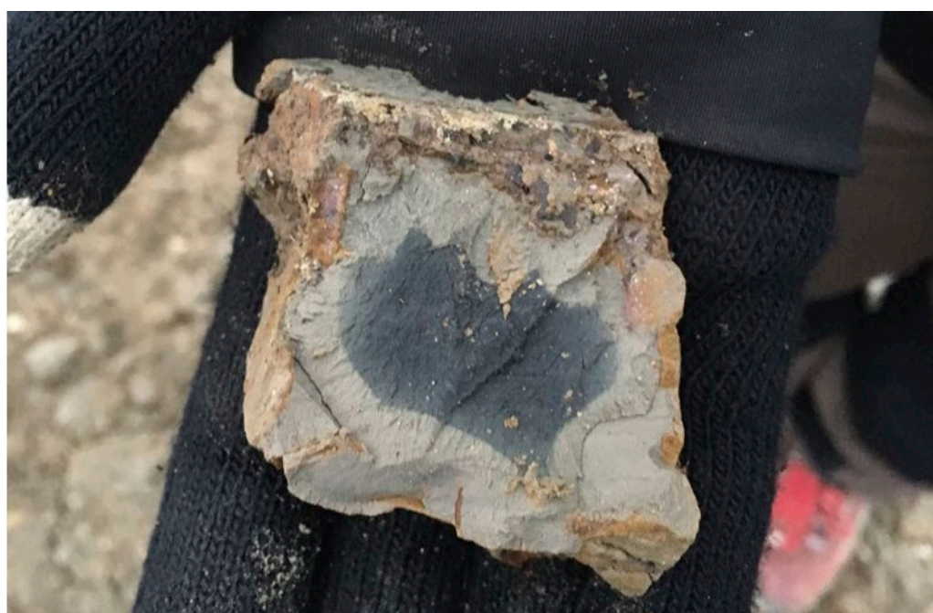
Kuva 2.7. Maanäytteen keskellä on mustaa, hapettumatonta maa-ainesta, joka viittaa siihen, että pyriitin lisäksi näytteessä on monosulfideja. Näytteen ympärillä maa-aines on jo hapettunut ja muuttunut väritään harmaaksi. Maanäytteen hapettuneesta kerroksesta on tunnistettavissa myös punertavia rautasaostumia. Maiju Nylund Ramboll Finland Oy.
