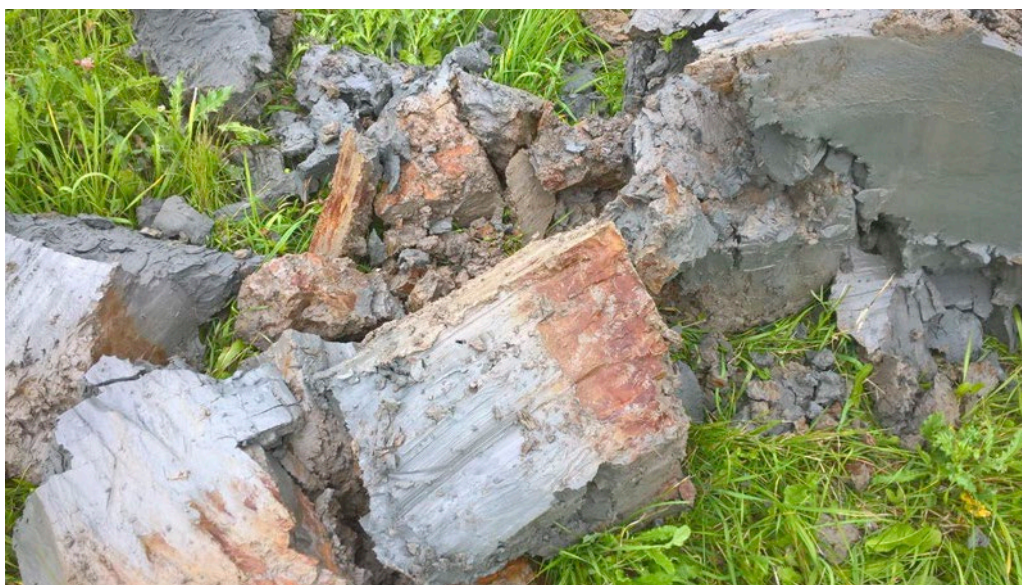
Kuva 2.7. Maanäytteen keskellä on mustaa, hapettumatonta maa-ainesta, joka viittaa siihen, että pyriitin lisäksi näytteessä on monosulfideja. Näytteen ympärillä maa-aines on jo hapettunut ja muuttunut väritään harmaaksi. Maanäytteen hapettuneesta kerroksesta on tunnistettavissa myös punertavia rautasaostumia. Maiju Nylund Ramboll Finland Oy.
