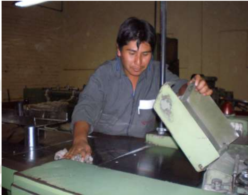
Figura N° 34: Retiro de la guarda de protección Fuente: NELANA S.A.C.
