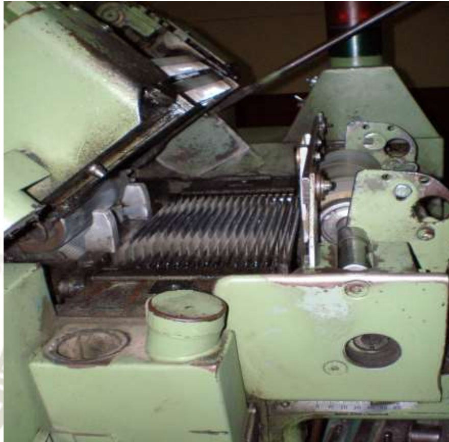
Figura N° 35: Verificación de las barretas en el cabezal de la máquina Fuente: NELANA S.A.C.
