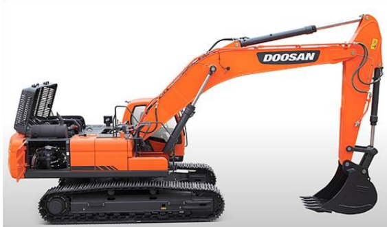
Excavadora sobre oruga
