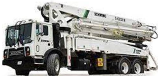
Pluma para el vaciado de concreto
