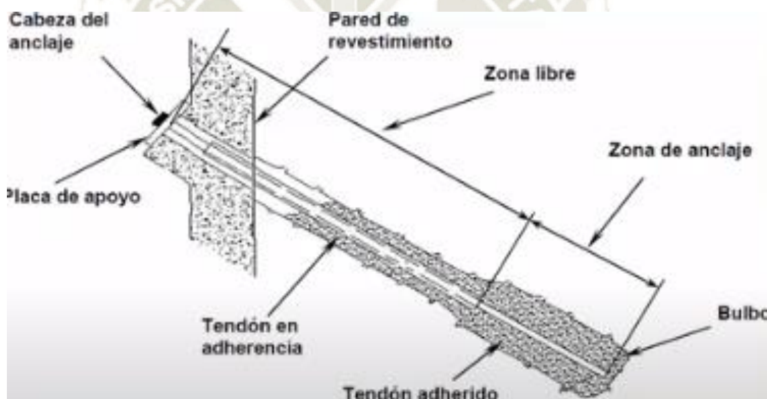
Figura 21. Esquema de muro anclado con partes
