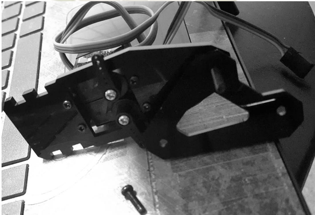
Figura 51 Ensamble de una extremidad del robot
