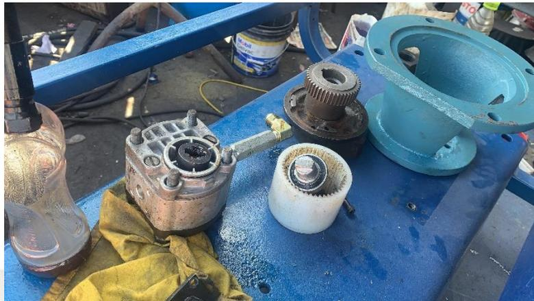
**Figura 78 Bomba hidráulica y acople motor**
