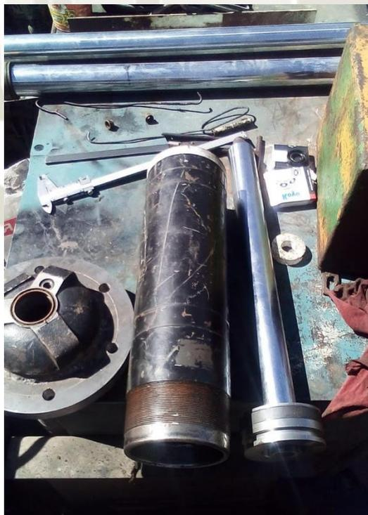
**Figura 77 Camiseta y vástago de pistón hidráulico**
