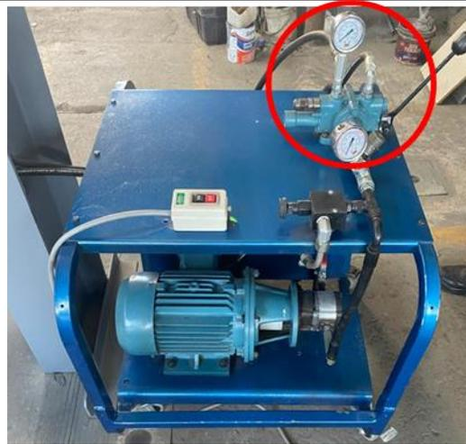
17. Una vez producido la ruptura de la probeta apagar el equipo hidráulico y luego proceder con el desmontaje de la probeta para la toma de medidas finales de elongación.
