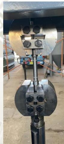
13. Ajustar mordazas a través de los pernos de ajustes de cada cabezal superior e inferior con los pernos allen cabeza cilíndrica, para evitar el deslizamiento de la probeta una vez iniciado el ensayo.
