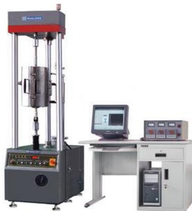
**Figura 11 Máquina de ensayo de tracción controlado por ordenador /
