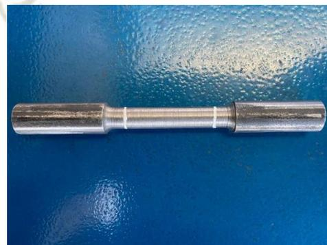
12. Posicionar la probeta en las mordazas superior e inferior, si es necesario, maniobrar la carrera de pistón para el posicionamiento deseado.
