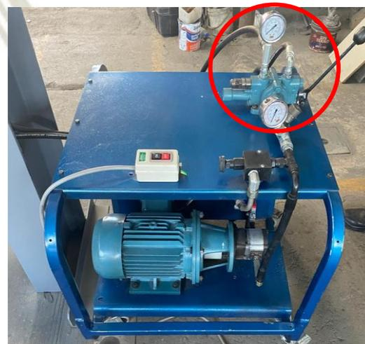
16. Luego de iniciar el ensayo a través de la válvula direccional, registrar la presión máxima que se visualiza en el manómetro.
