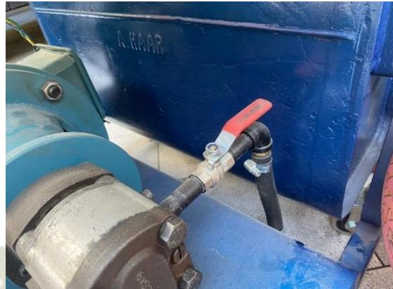
2. Verificar que la válvula reguladora de caudal este completamente abierta.
