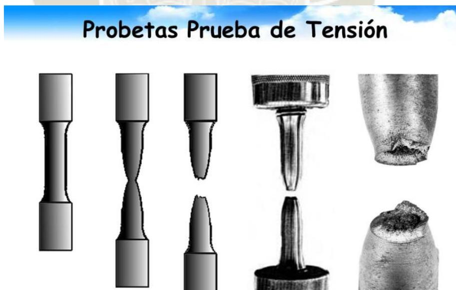
**Figura 2 Deformación probeta**
