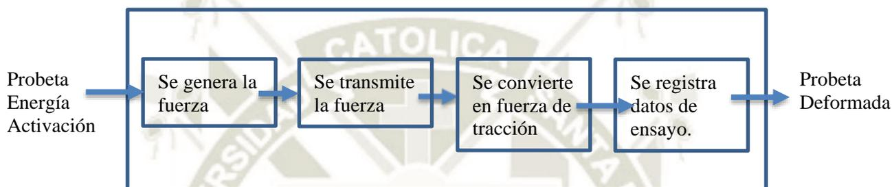
**Figura 15 Estructura de funciones**
