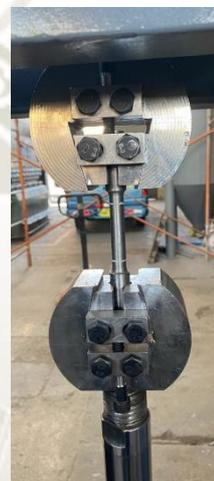
13. Ajustar mordazas a través de los pernos de ajustes de cada cabezal superior e inferior con los pernos allen cabeza cilíndrica, el ajuste se realiza a través de una llave allen 8 mm, para evitar el deslizamiento de la probeta una vez iniciado el ensayo.
