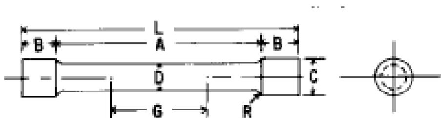
**Figura 80 Preparación de probeta**
