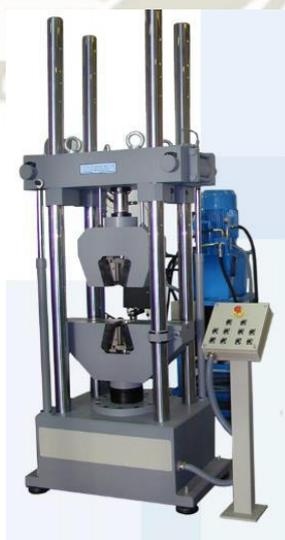
**Figura 12 Máquina de ensayos de tracción hidráulica**
