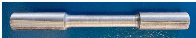
**Figura 83 Probeta Aluminio 6061T4**
