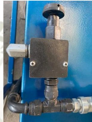
Válvula direccional  $P_{max}=350$  bar
