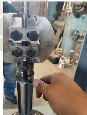
14. Generar una precarga con la válvula direccional en la posición de avance, para un mejor ajuste y agarre de la probeta.
