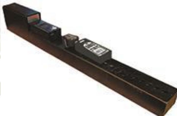
**Figura 8 Máquina de ensayo de Tracción neumático**
