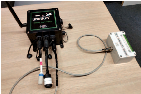
Abbildung 4: Waspote mit angeschlossener A/D-Wandler Box.
