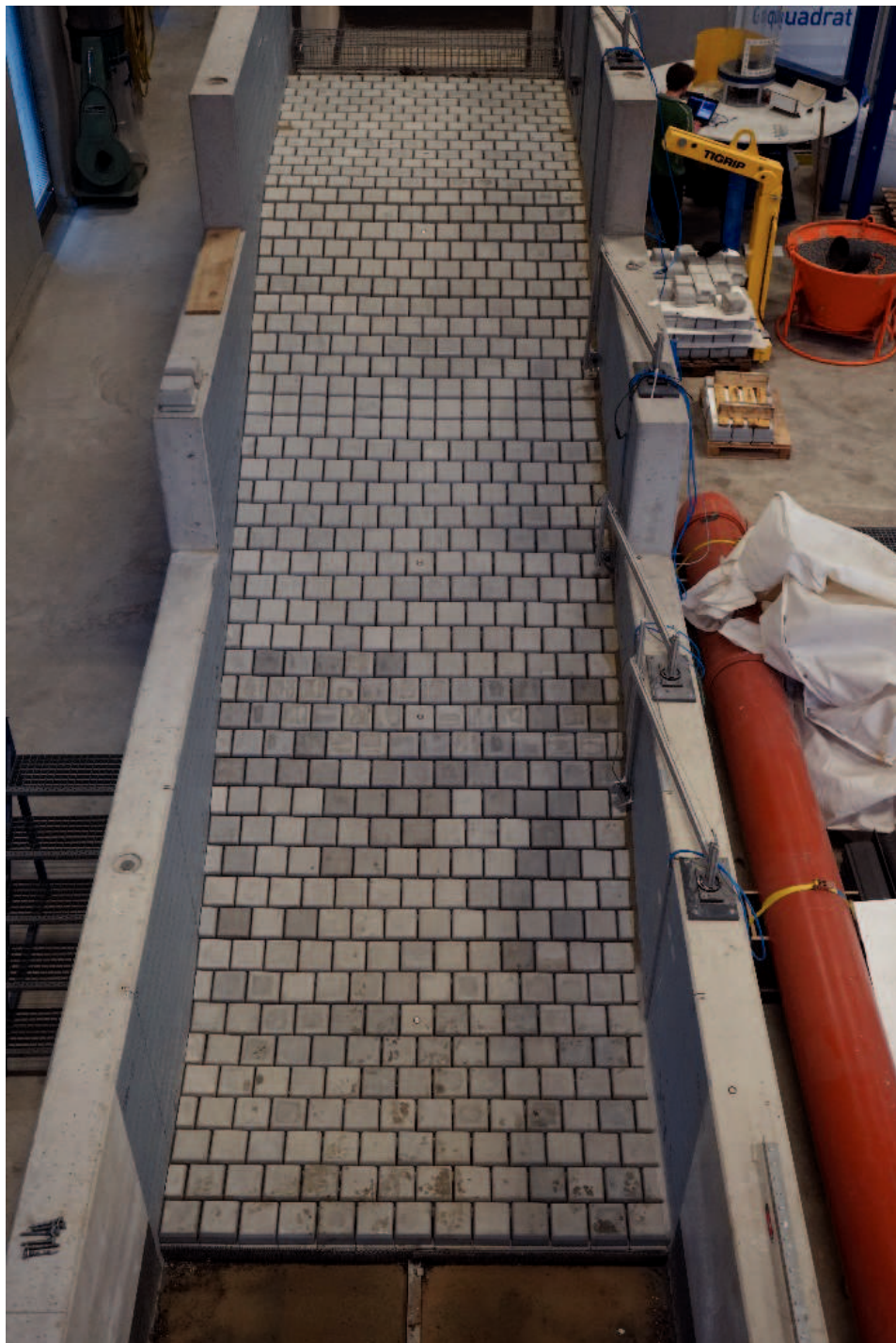
Abbildung 15: Der aufgebaute Modelldamm in der Draufsicht (Messtechnik eingeklappt).
