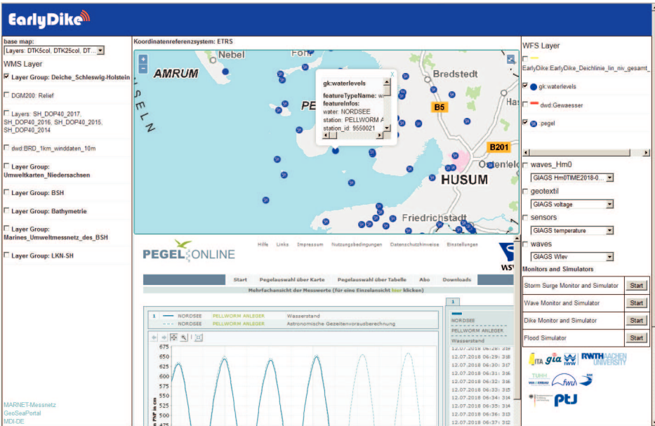
Abbildung 16: WFS der Pegeldaten der WSV und der Umweltverwaltung Schleswig-Holstein mit REST-Schnittstelle des Gewässerkundlichen Informationssystems der WSV (Pegelonline).
