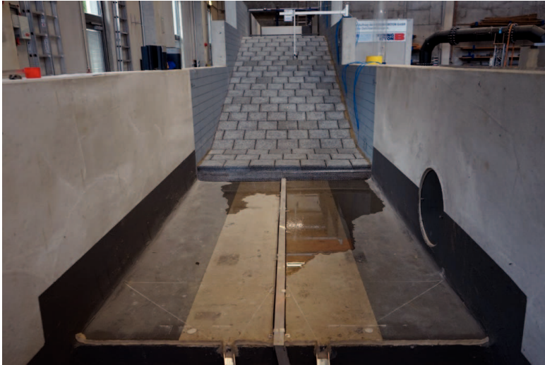
Abbildung 19: Erster Sickerwasseraustritt am Deichfuß.
