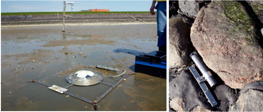
Abbildung 6: Links: „ADCP 1“ („Workhorse Sentinel 1200“) und Messpfahl „Untjehörn“ (im Hintergrund), rechts: mobile 10 Hz-Druckmesssonde am Deichfuß.
