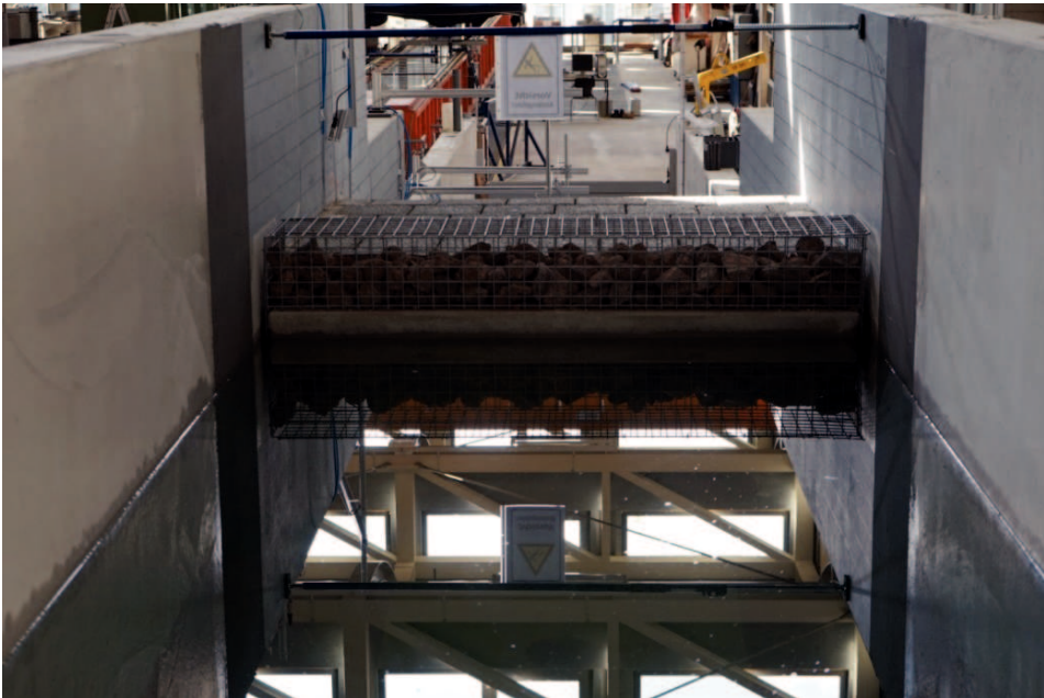
Abbildung 18: Einstau des Modelldeichs für Durchsickerungsversuche.
