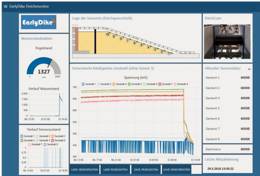
Abbildung 39: Screenshot des Deich-Dashboards für den Modelldeich kurz nach erfolgtem Überströmereignis.
