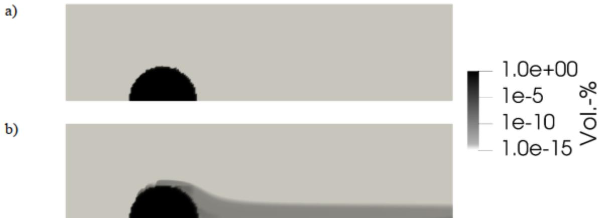
Abbildung 4.2: Ergebnis der numerischen Simulation zum Zeitpunkt  $T_{\text{Sim}} = 1800$  s für den Maßstab der Großausführung mit  $a = 58$  cm und einer Filtergeschwindigkeit von 1 m/d (a) und 100 m/d (b)
