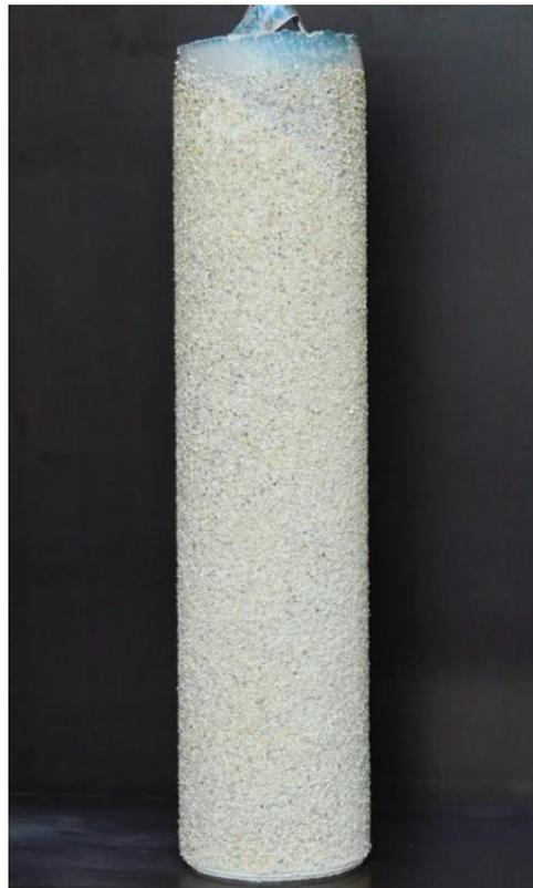
Abbildung 3.2: Verrohrt hergestellte Modellpfähle mit GK8:
