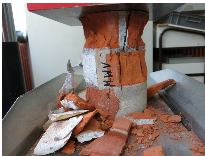
Bild 1: Druckfestigkeitsprüfung eines Vertikalbohrkerns.
