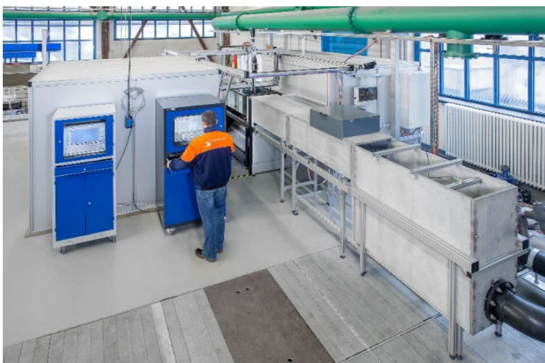
Bild 1: Ansicht des PIV-Versuchsstandes mit dem Maßstabsmodell des ethohydraulischen Versuchsaufbaus.
