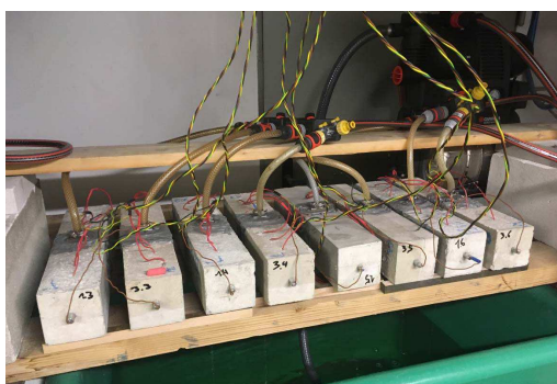
Bild 1: Prüfkörper mit Elektroden (Pollner und Dauberschmidt 2021).
