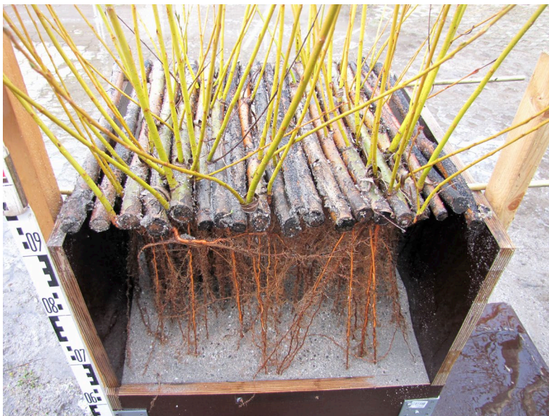
Bild 1: Freigespülte Weidenwurzeln eines Laborversuches.
