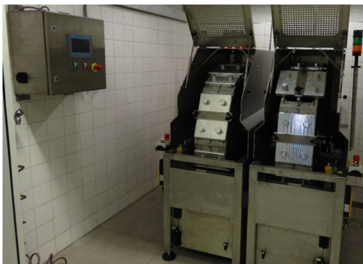
Bild 1: Versuchsstand zur Prüfung des Abriebwiderstands: BAW-Abriekammer.
