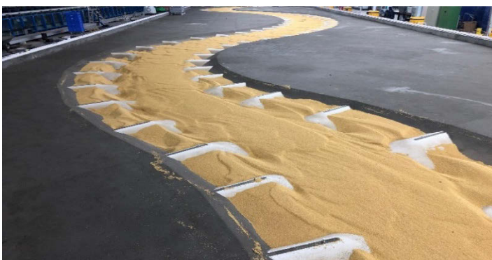
Bild 1: Mit Granulat gefülltes Krümmungsmodell mit Dünen und Buhnenkopfkolken. Blick gegen die Fließrichtung.
