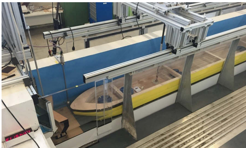
Bild 1: Gegenständliches Schleusenmodell zur Validierung numerischer Simulationsergebnisse.
