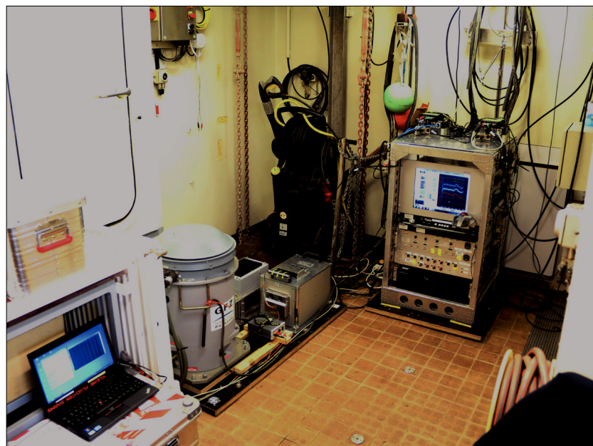
Abb. 5: Gravimetrisches Instrumentarium im Nasslabor an Bord des VWFS Deneb . Das Chekan-Gravimeter des GFZ Potsdam (Aufkleber) ist auf einer Grundplatte montiert, welche neben Steuergeräten auch das inertielle Messsystem der TU Darmstadt trägt. Rechts hinten befindet sich ein Rack mit dem Steuerrechner für das Chekan-Gravimeter, mit vier GNSS-Empfängern und zwei weiteren Computern. Das System ist für die dynamischen Bedingungen einer bewegten Messplattform (z. B. Flugzeug, Schiff) ausgelegt
