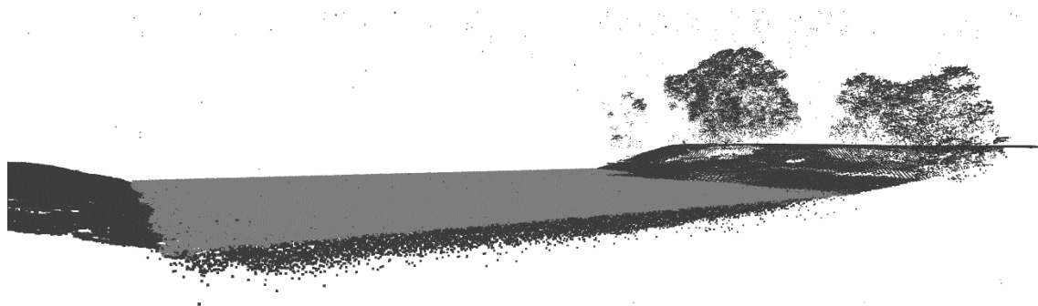
Abb. 3: Klassifizierung des Wasserkörpers in perspektivischer Ansicht (aufgrund eines Schwellwertes für die Abweichung vom exponentiellen Verlauf der FWF-Amplitude: schwarz kein Wasserkörper (Vorland & Vegetation); dunkelgrau (letzter Peak in FWF) bzw. hellgrau (erster Peak in FWF) in der Bildmitte ist Wasserkörper).
