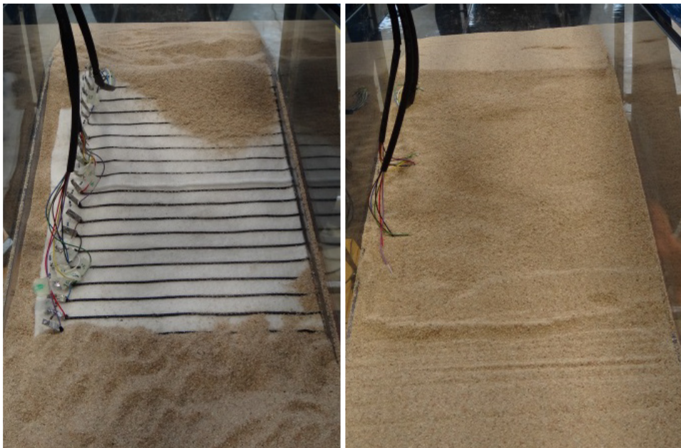
Abbildung 9: Einbau von Messvlies I im kleinmaßstäblichen Dammmodell.
