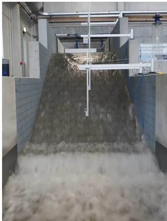
Abbildung 20: Modelldeich während Überströmversuch.
