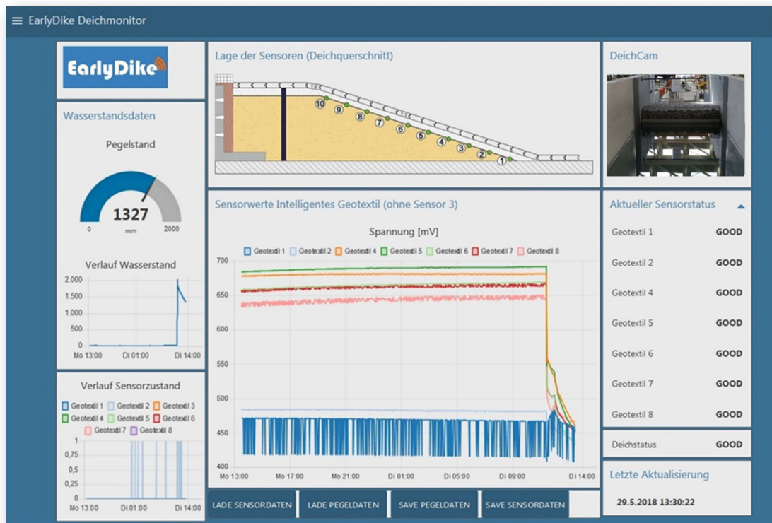
Abbildung 39: Screenshot des Deich-Dashboards für den Modelldiich kurz nach erfolgtem Überströmereignis.
