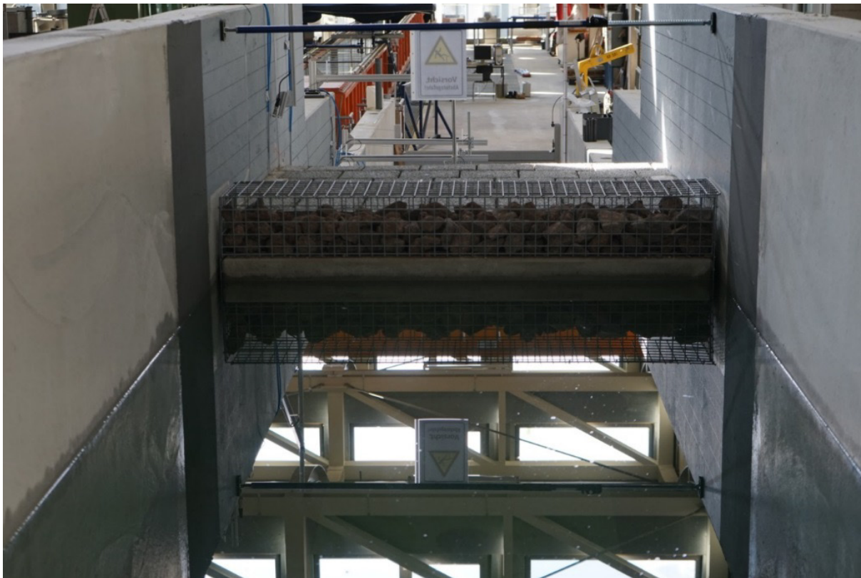
Abbildung 18: Einstau des Modelldeichs für Durchsickerungsversuche.
