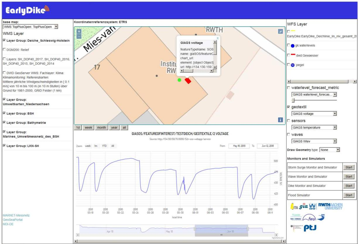
Abbildung 17: Geoportal – Spannungsmesswerte eines Geotextils.
