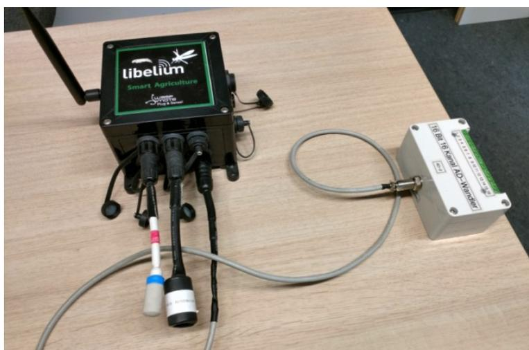
Abbildung 4: Waspnote mit angeschlossener A/D-Wandler Box.
