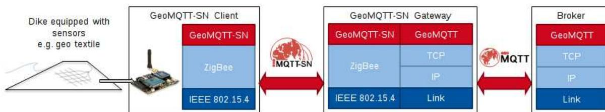
Abbildung 8: Anbindung von Sensorknoten an einen GeoMQTT-Broker.
