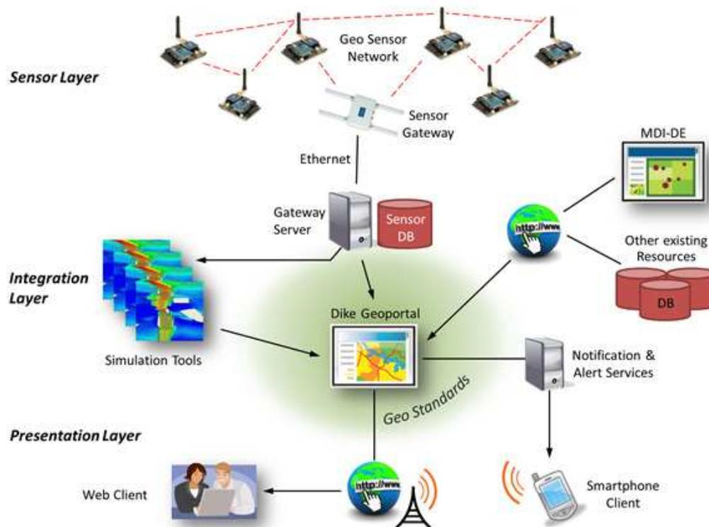
Abbildung 1: Sensor- und räumliche Dateninfrastruktur für das Deich-Monitoring.
