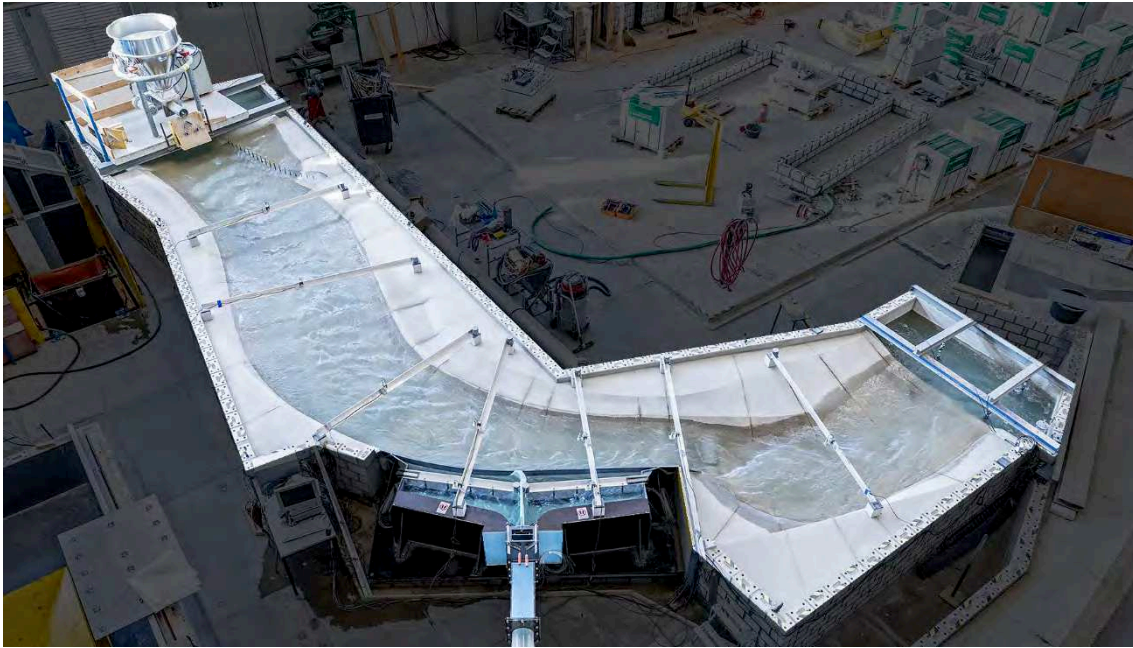
Abb. 2: Physikalisches Modell des Einlaufbauwerks im Massstab 1:30 beim Dimensionierungsabfluss ( HQ_{500} = 600 \text{ m}^3/\text{s} ).
